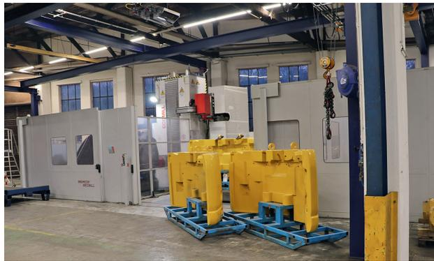
4 Seit März 2021 ist die Ecomill von Emco bei Komatsu Germany im Einsatz. Dank der hohen Flexibilität der Fahrständerfräsmaschine ersetzt diese Maschine zwei bisherige Bearbeitungszentren und ermöglicht eine Ein-Linien-Produktion © Emco
