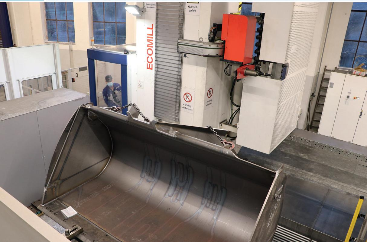
1 Auf der Fahrständerräsmaschine von Emco werden H8-Passungen für verschiedene Hauptkomponenten der Komatsu-Baufahrzeuge bearbeitet – Schaufel und Ausleger ebenso wie Vorder- und Hinterrahmen
